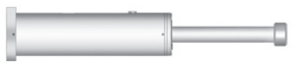
FR:뒤 클램프 조립 방식 주: 완충 스트로크가 300mm 이상시 뒤 클램프 조립 방식을 사용하지 않다고 권장합니다.
